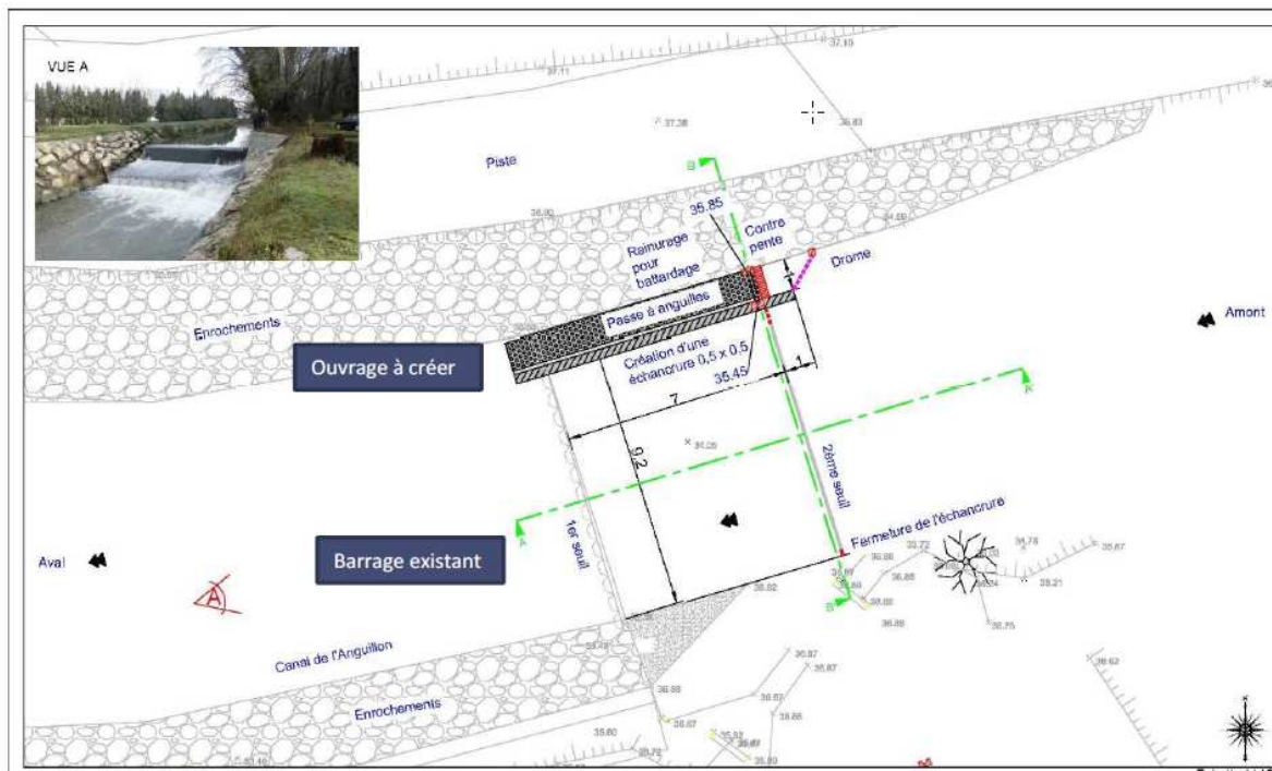
Figure 2: Plan masse de l'aménagement du seuil du Réal
